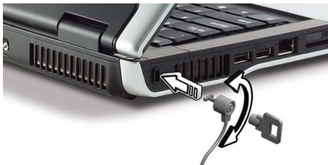
Připevněte bezpečnostní kabel k nehybnému předmětu, například ke stolu nebo rukojeti uzamčené zásuvky. Vložte zámek do drážky a otočením klíče zámek zamkněte.
