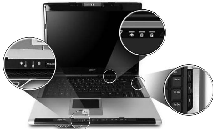
Stavové indikátory na předním panelu jsou viditelné i po zavření víka počítače.
